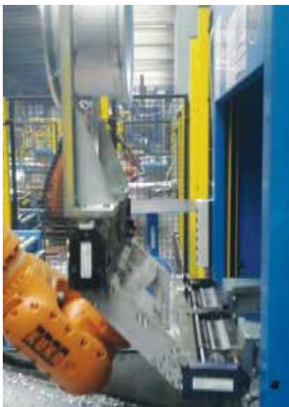
GRR气爪并不需要对机加金属碎屑的特殊防护
