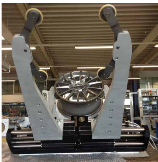
Pincés GRR présentés sans protection protégeant l'arbre de guidage des copeaux de la machine.
